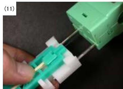
(※) 0.5mmのインドアケーブルを使用する場合、0.5mm用のストリッパで被覆を除去してから0.25mm用のストリッパで被覆を除去します。
